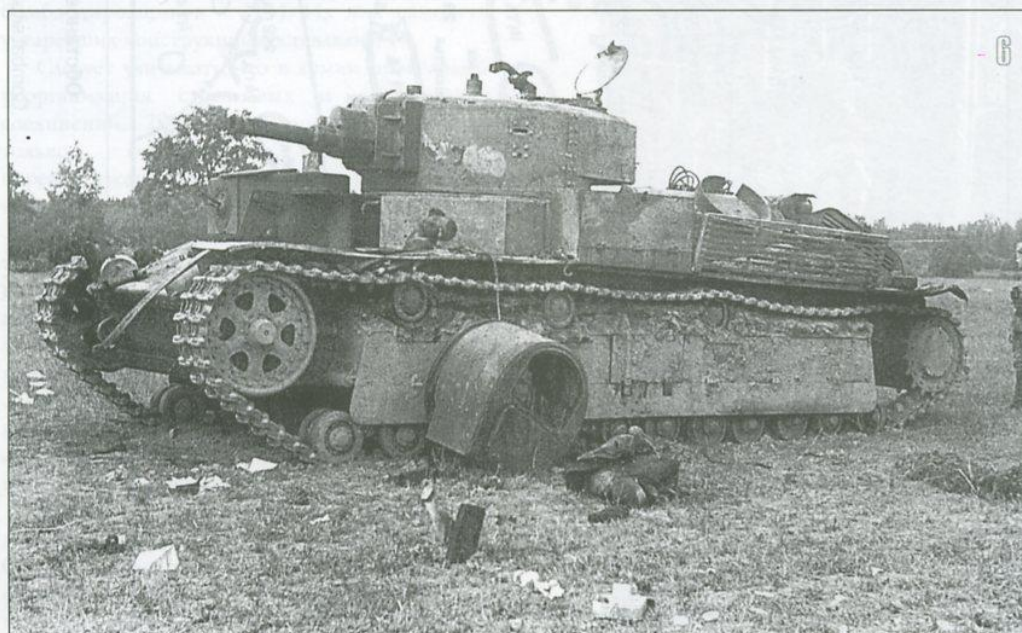
6. Подбитый немецким войсками средний танк Т-28 из состава 15-го механизированного корпуса РККА. Танк оснащен 76,2-мм пушкой Л-10. Вероятно, танк был подбит в результате атаки с воздуха. Западная Украина, июнь 1941 года (Bundesarchiv).
