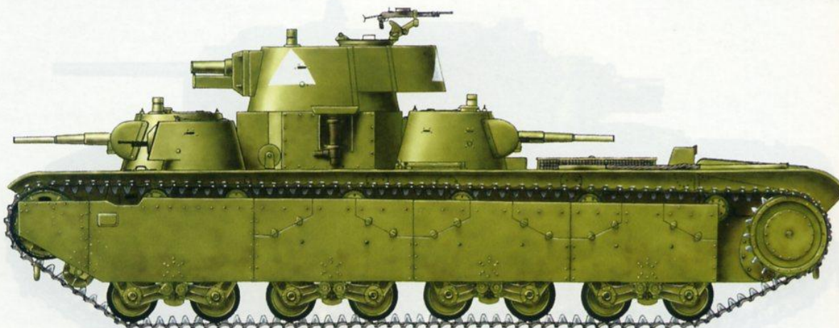
Тяжелый танк Т-35 (выпуска февраля-апреля 1939 года, модификация с прямой подбашенной коробкой и коническими башнями) 68 тп 34 тд 8 мк РККА. Юго-Западный фронт, июнь 1941 года. T-35 tank (February-April model 1939, modification with a straight-cornered box under turret and with conical turrets) organic to 68th Tank Regiment of 34th Tank Division of 8th Mechanized Corps. South-Western Front, June 1941.
