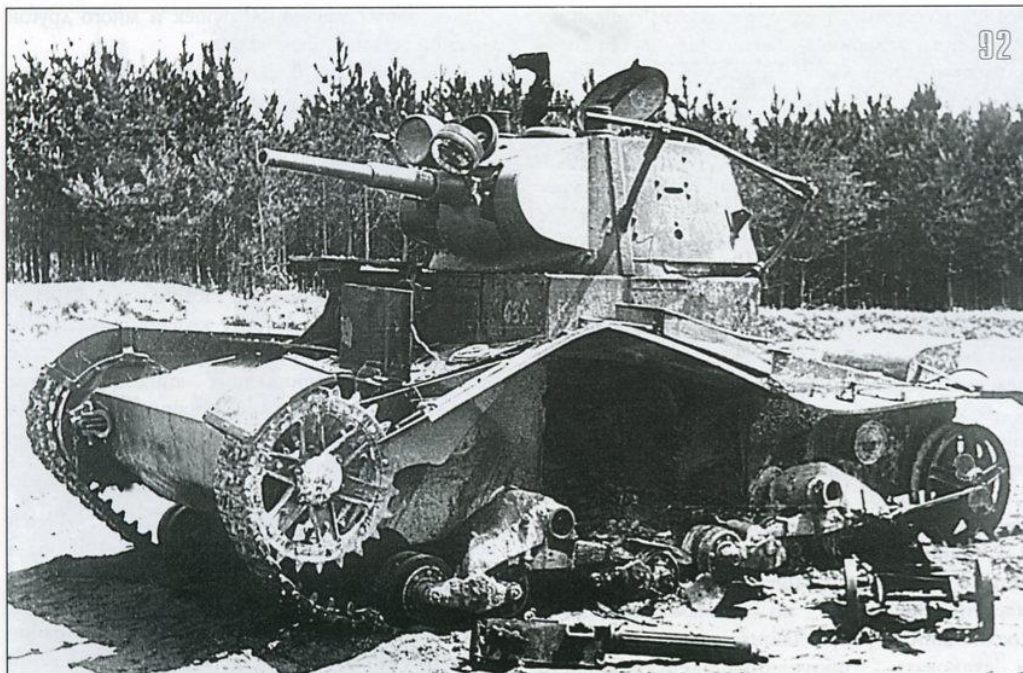
92. Т-26 образца 1938 года, оборудованный поручневой радиоантенной. Именно такие танки наиболее часто использовались в качестве командирских машин. Данный образец оборудован фарами боевого света. Юго-Западный фронт, июль 1941 года (АВЛ).
